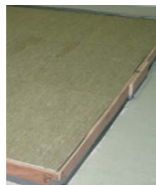
2 x 50 мм SeaRox SL 340 при проверке на звукопоглощение
